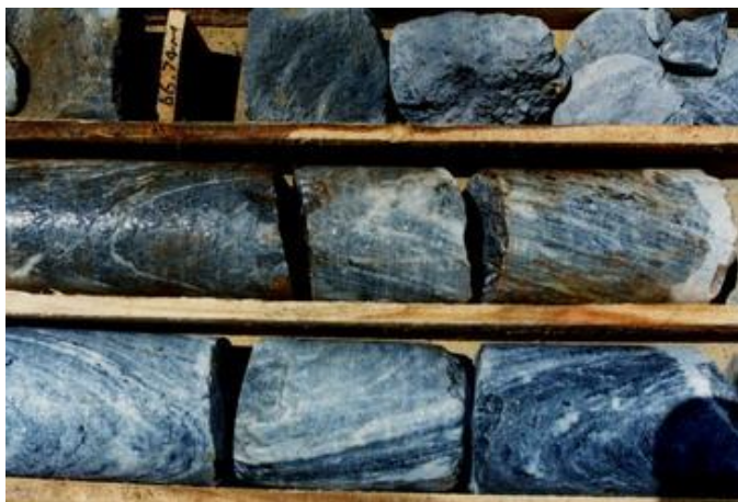
圖 4 原生的具條帶狀構造的大理岩
