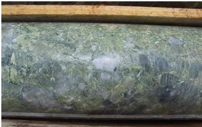
圖 12 矽卡岩化角礫狀大理岩岩芯
