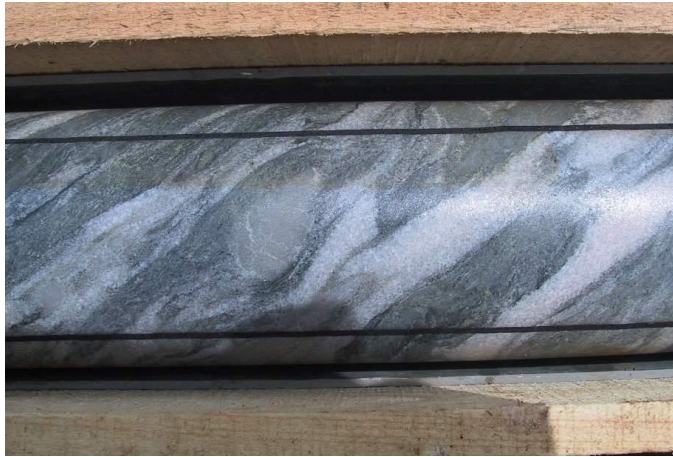
圖 3 變形具條帶狀構造的含大理岩碎塊的火山角礫岩
