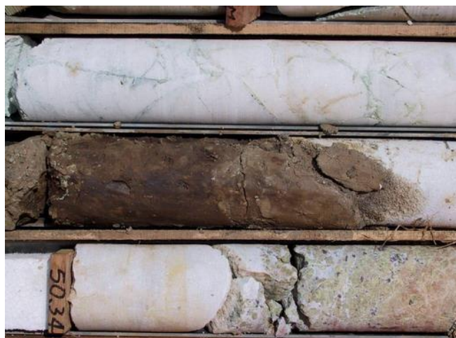
圖 6 鑽探岩芯中的大理岩及溶洞充填
